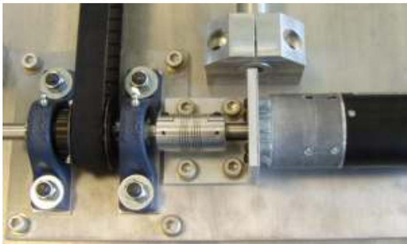
Figur 5: Koblingen forbinder motoren med akslen.
